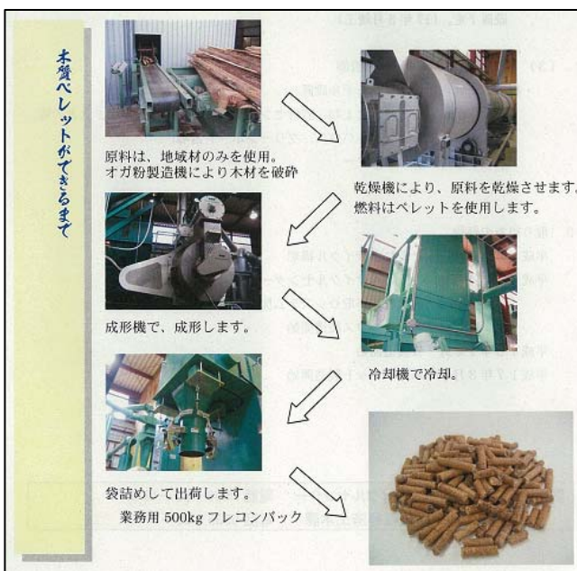
図4 とよね木サイクルセンターのペレットの製造工程
