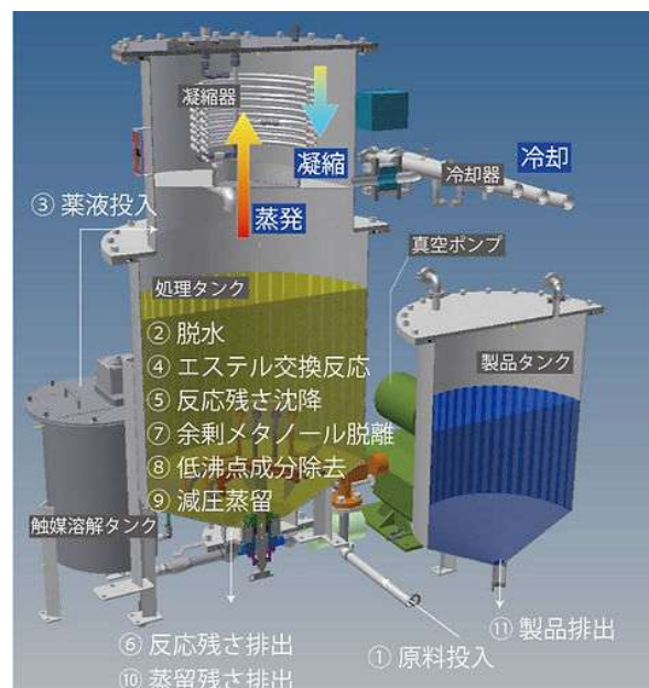
図1 減圧蒸留装置 1)
